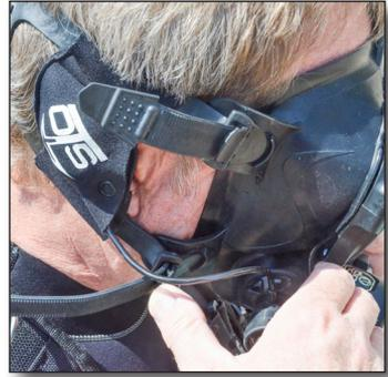
Figure 23 : Pour retirer le masque, utilisez les pouces pour saisir les languettes d'attache inférieure et desserrez
